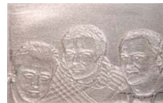
Gefrästes Bild aus Fotovorlage
