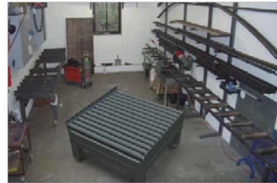
Bild 7: Rollenführungsbahn in Werkstatt
